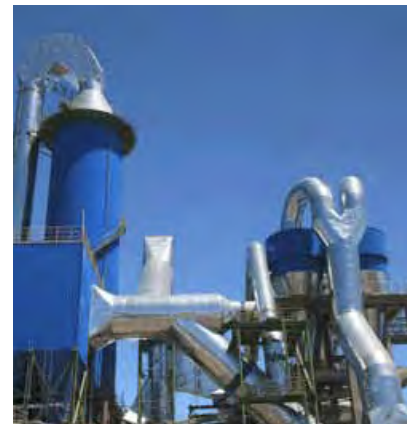
▲ Installation de dépoussiérage du broyeur cru dans l'usine de Jambyl Cement à Mynaral (Kazakhstan)
