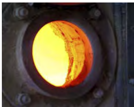
▲ Vue par un œilleton de l'intérieur d'un four en cimenterie
