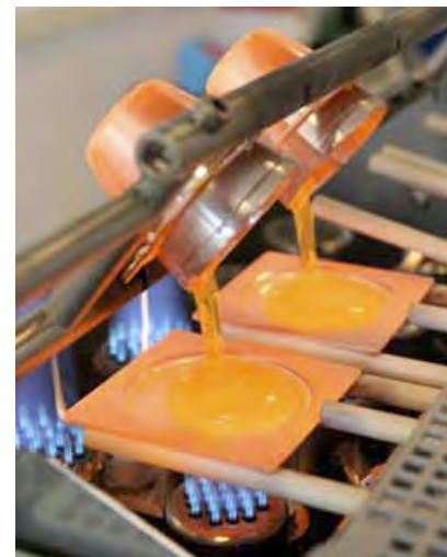
▼ Préparation de perles par fusion pour la fluorescence X
