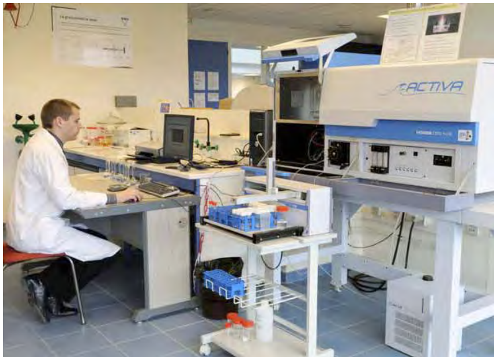
▲ Spectrométrie par torche à plasma dans le laboratoire matériaux et microstructures du centre technique Louis Vicat à L'Isle d'Abeau (France)
