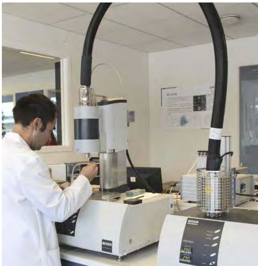
◀ Analyse thermogravimétrique couplée à un analyseur spectromètre de masse dans le laboratoire matériaux et microstructures du centre technique Louis Vicat à L'Isle d'Abeau (France)
