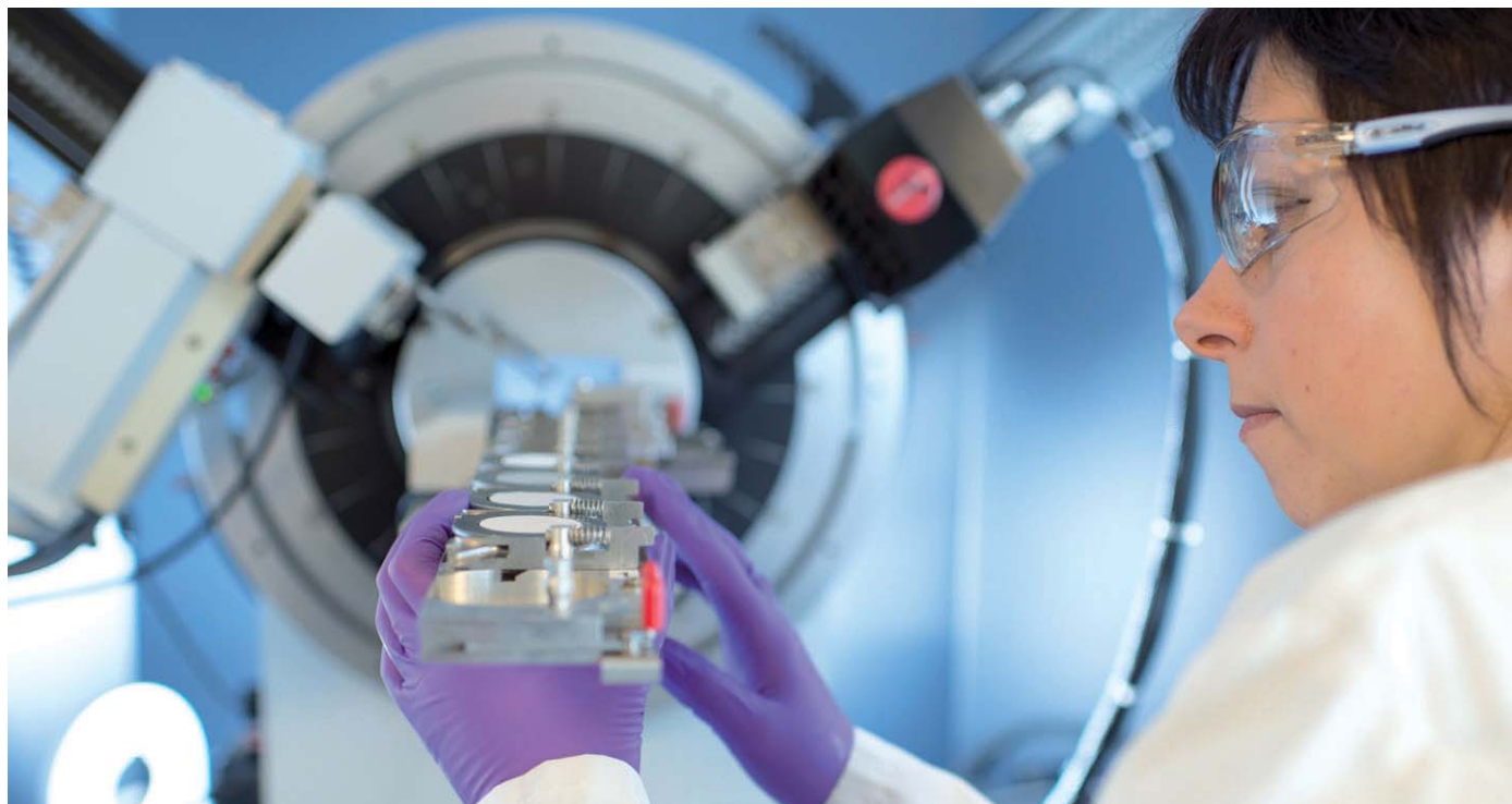
▲ Diffractométrie de rayons X à détecteur rapide du laboratoire matériaux et microstructures du centre technique Louis Vicat à L'Isle d'Abeau (France).
